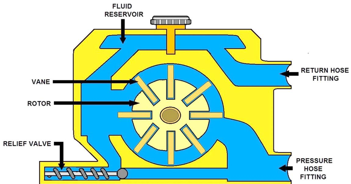
**FLEX VANE PUMP DIAGRAM**
