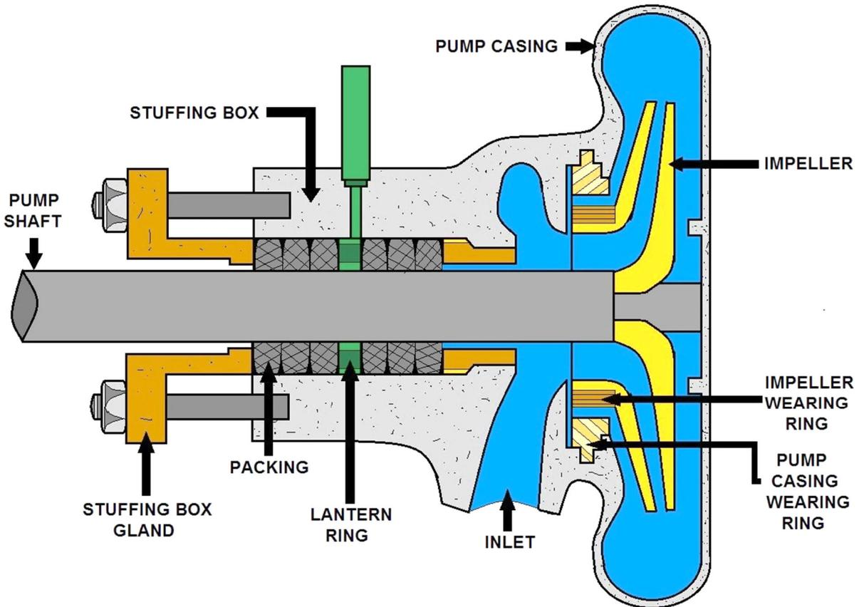
**CENTRIFUGAL PUMP BREAKDOWN**
