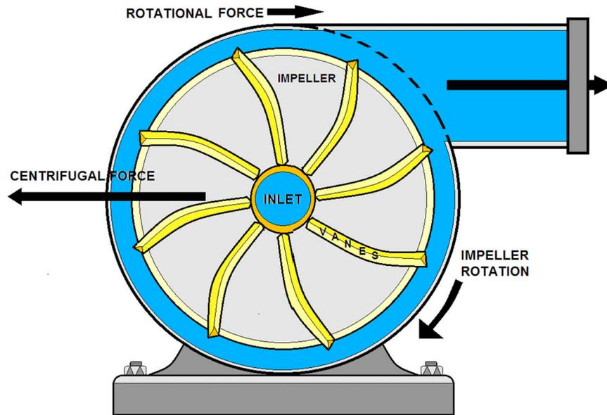
**BASIC PUMP IMPELLER DIAGRAM**
