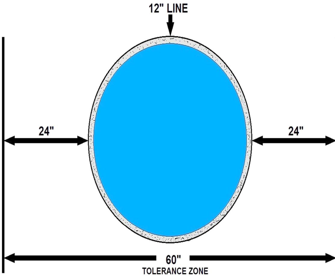
**TOLERANCE ZONES USED TO AVOID HITTING UTILITES WHILE EXCAVATING**
