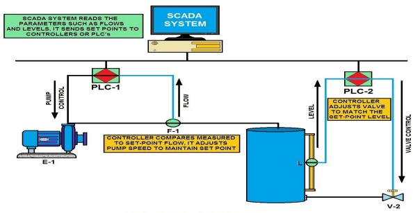
SCADA SYSTEM (SUPERVISORY CONTROL and DATA ACQUISITION)
