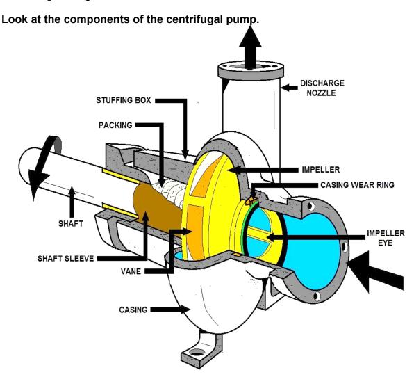
**CENTRIFUGAL PUMP BREAKDOWN DIAGRAM #1**
