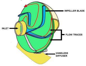
**COMMON PUMP IMPELLER**
