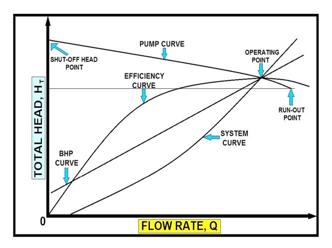
PUMP PERFORMANCE CURVE (CENTRIFUGAL PUMP)
