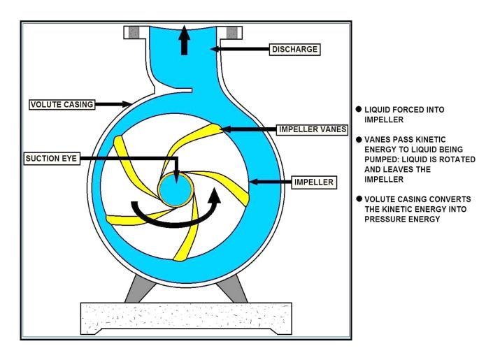
**HOW A CENTRIFUGAL PUMP WORKS**
