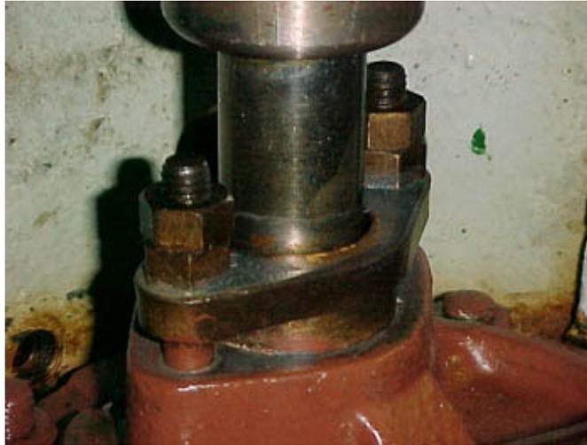
**PUMP PACKING BOX WITH ADJUSTMENT LOCK NUTS**
