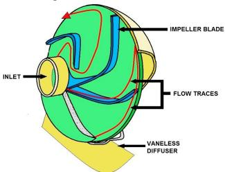
**COMMON PUMP IMPELLER**
