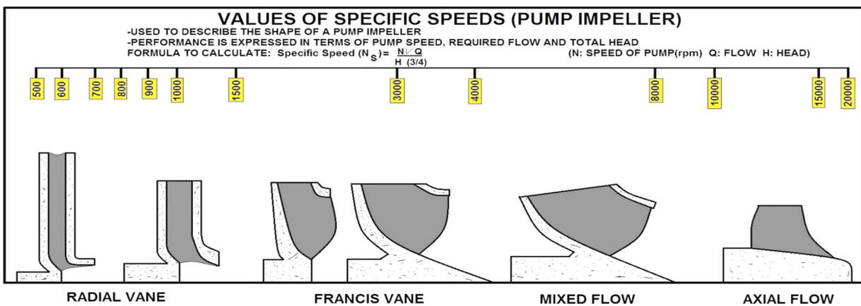
**IMPELLER SPECIFIC SPEEDS - IMPELLER VANE CROSS SECTION**
