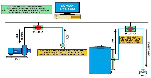
SCADA SYSTEM (SUPERVISORY CONTROL and DATA ACQUISITION)
