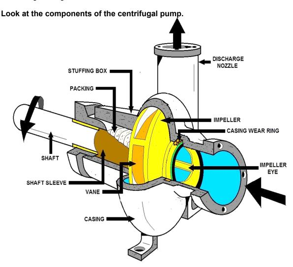
**CENTRIFUGAL PUMP BREAKDOWN DIAGRAM #1**
