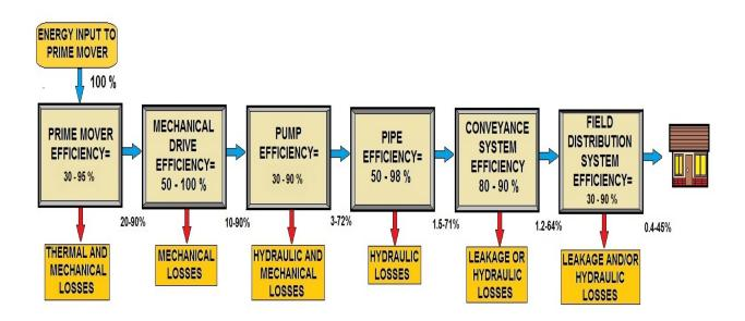
SYSTEM ENERGY EFFICIENCY LOSSES DIAGRAM
