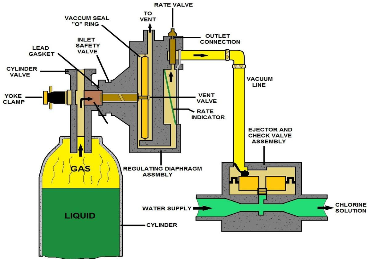
**150 LB SINGLE CHLORINE CYLINDER CHLORINATOR DIAGRAM #1**
