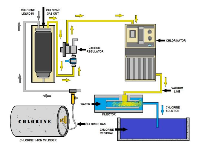
CHLORINE EVAPORATOR - CHLORINATION DIAGRAM
