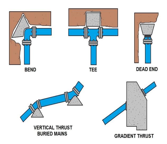
PROPER THRUST BLOCKING PROCEDURES
