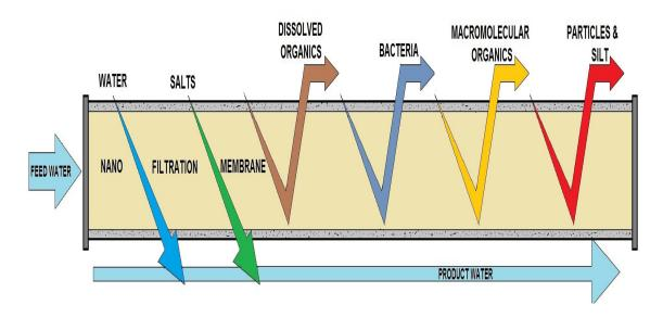
NANOFILTRATION FILTRATION DIAGRAM
