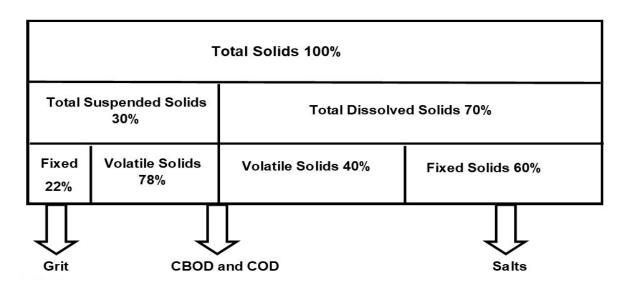
**WASTEWATER SOLIDS BREAKDOWN DIAGRAM**
