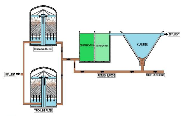
SINGLE-STAGE TRICKLING FILTERS IN PARALLEL
