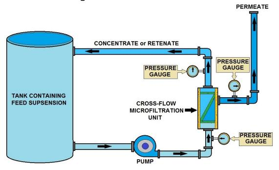
**MICROFILTRATION SYSTEM DIAGRAM**
