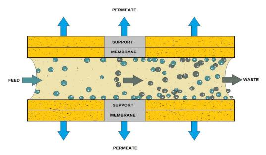
TUBULAR MEMBRANE FILTRATION DIAGRAM
