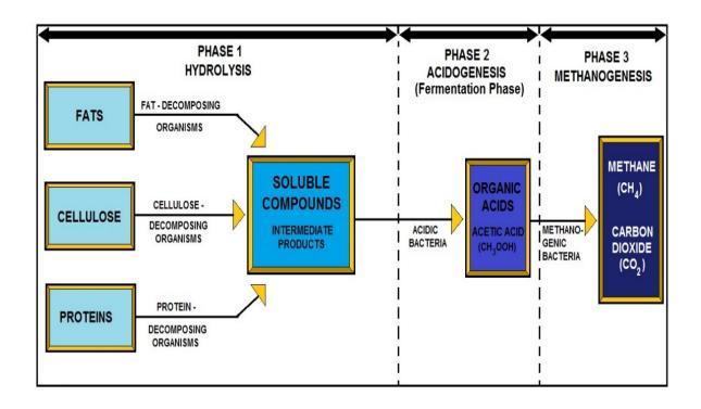
**ANAEROBIC DECOMPOSITION DIAGRAM**
