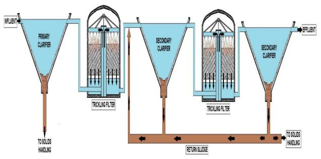
**DOUBLE STAGE TRICKLING FILTER**
