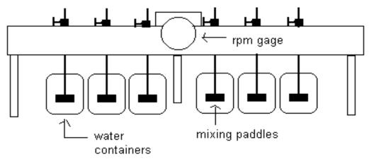
**JAR TESTING APPARATUS**
