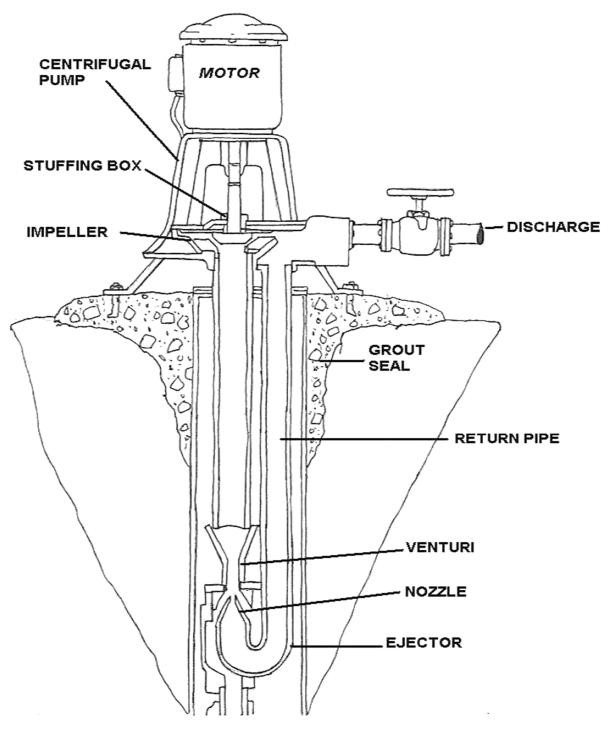
**VERTICAL TURBINE PUMP DIAGRAM #2**
