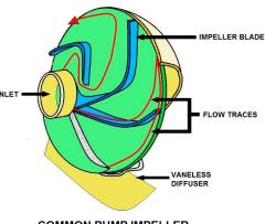
COMMON PUMP IMPELLER
