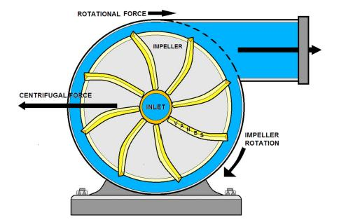
**BASIC PUMP IMPELLER DIAGRAM**
