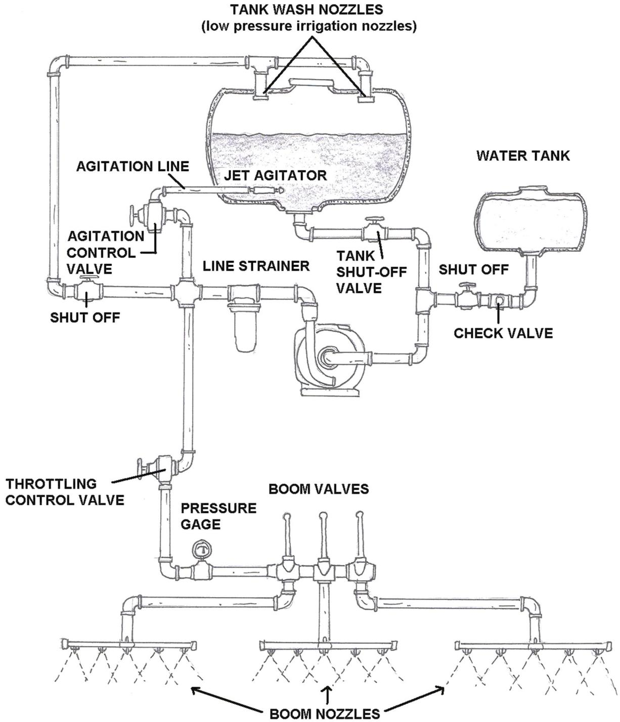
**BOOM SPRAYER SYSTEM DIAGRAM**
