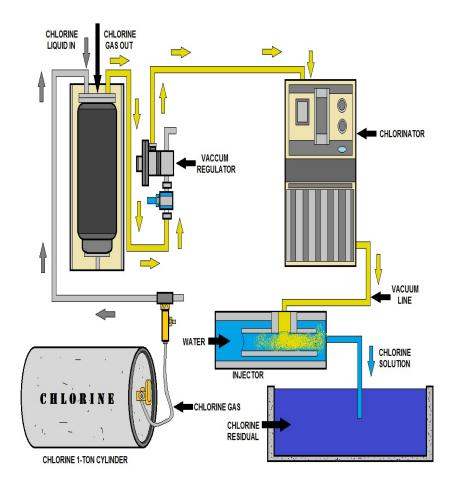
CHLORINE EVAPORATOR - CHLORINATION DIAGRAM
