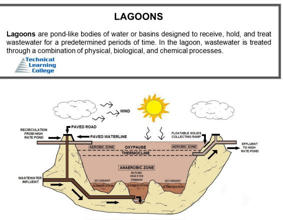
AEROBIC / ANAEROBIC POND
