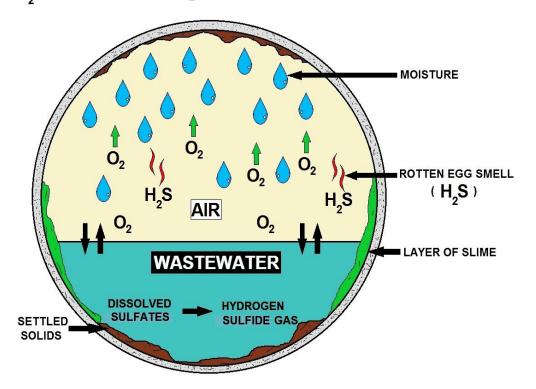
$H_{3}S$  BACTERIA + 20<sub>2</sub> = SULFURIC ACID  $\rightarrow$  CORROSION
