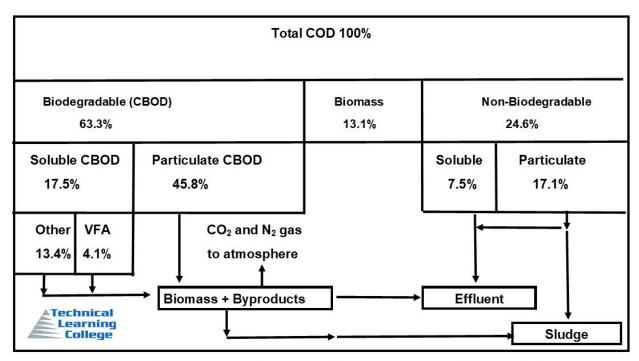
**ORGANIC WASTEWATER FRACTION BREAKDOWN DIAGRAM #1**
