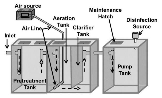
AEROBIC WASTEWATER TREATMENT SYSTEM DIAGRAM
