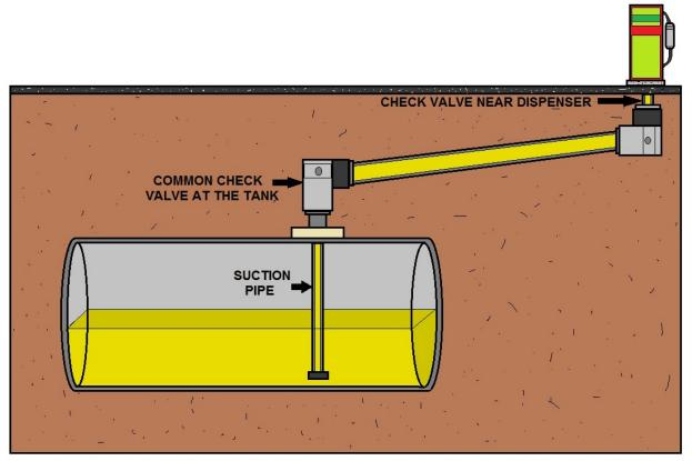
SUCTION PIPING FOR UNDERGROUND STORAGE TANK
