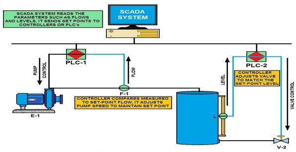
SCADA SYSTEM (SUPERVISORY CONTROL and DATA ACQUISITION)
