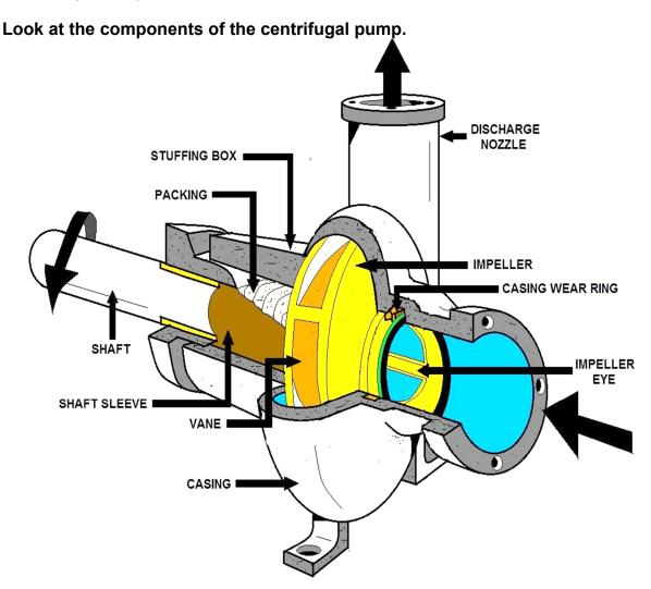
**CENTRIFUGAL PUMP BREAKDOWN DIAGRAM #1**
