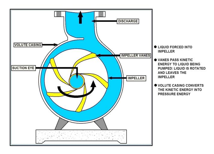
**HOW A CENTRIFUGAL PUMP WORKS**
