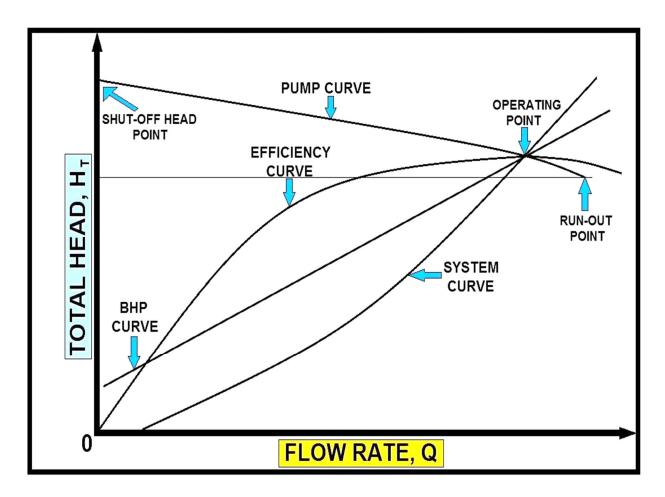
PUMP PERFORMANCE CURVE (CENTRIFUGAL PUMP)
