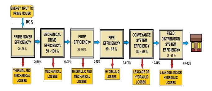
SYSTEM ENERGY EFFICIENCY LOSSES DIAGRAM
