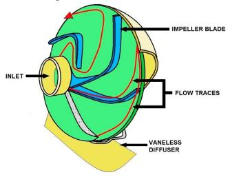
**COMMON PUMP IMPELLER**
