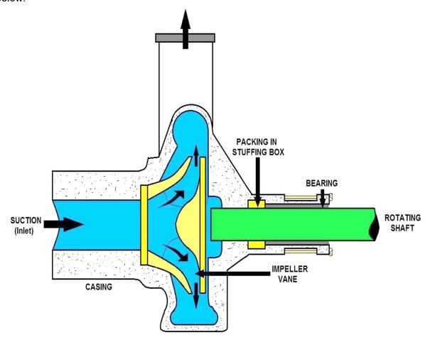
**CENTRIFUGAL PUMP BREAKDOWN DIAGRAM #2**
