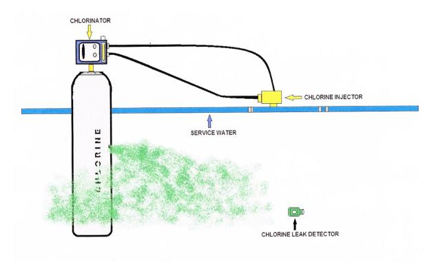
150 lb. CHLORINE CYLINDER LEAKING FROM SIDEWALL
